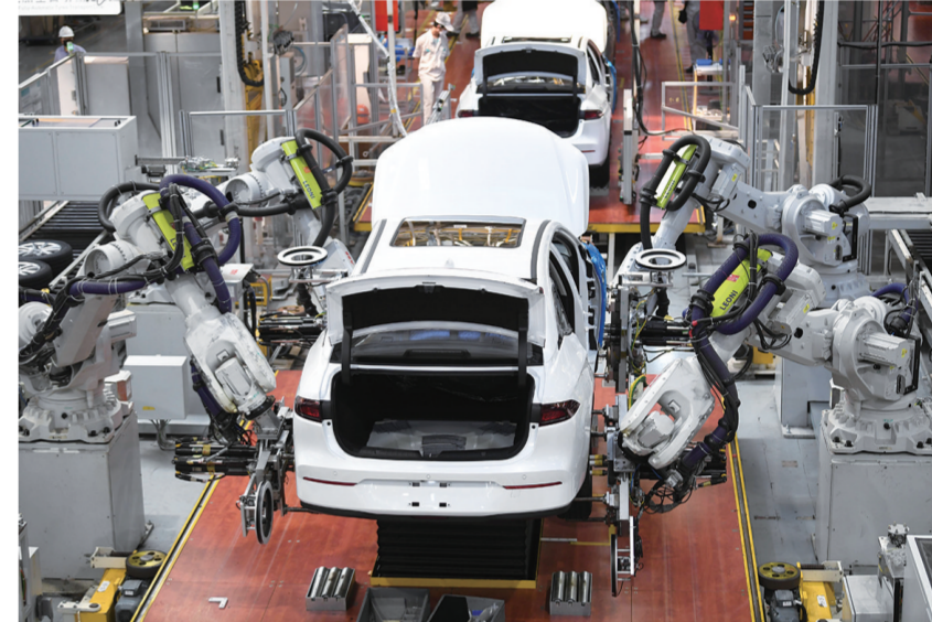
在广州市番禺区的广汽埃安新能源汽车股份有限公司总装生产线，机器人手臂在安装汽车轮胎（2023年2月24日摄）。
