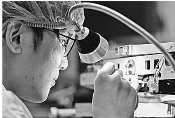
位于吉林省长春市的长光卫星技术股份有限公司科研人员装配光学遥感载荷组件。
